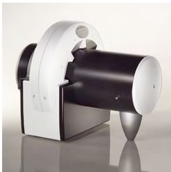
Fig. 2 : Scanner haute résolution permettant une lecture ultra-rapide de films sensibles d'une taille allant jusqu'à 35 x 43 cm. © Raytest
